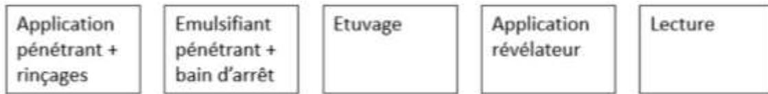
Figure 6 : Détail de la chaîne de ressuage
